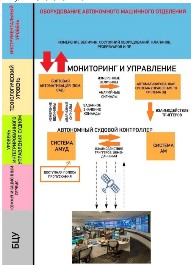
Рис. Структурное расположение АЕМС (АМУД) проекта «MUNIN»
