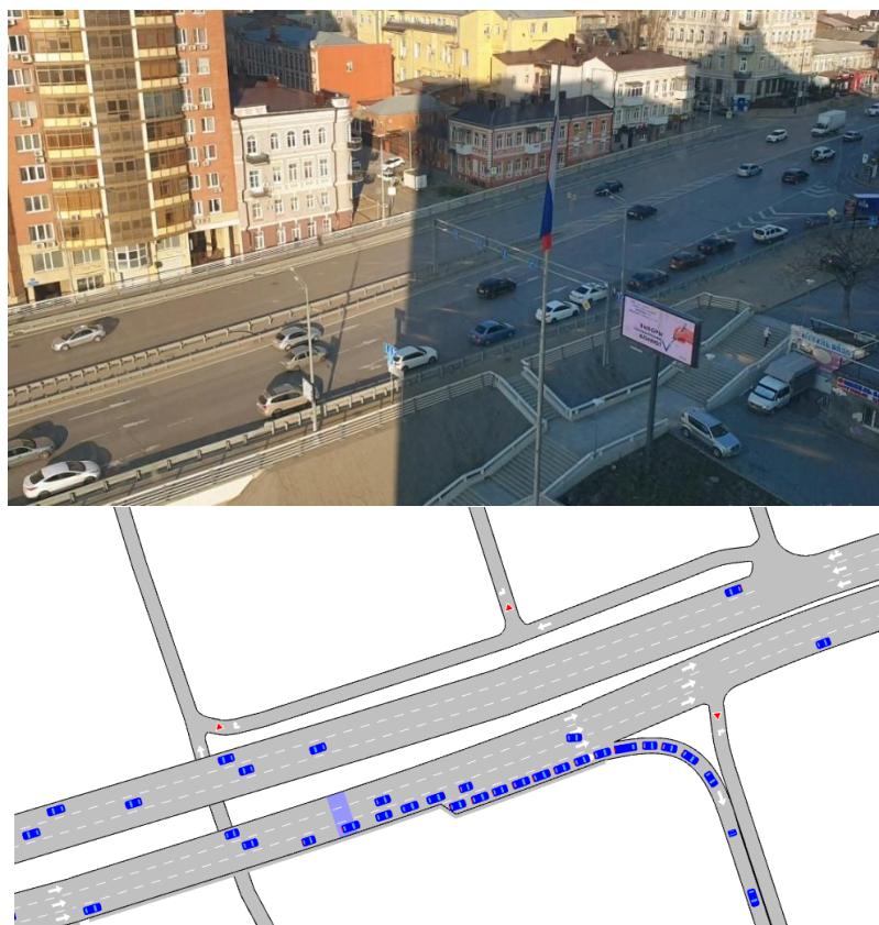
Рис. 4. Снимок состояния дорожного движения (сверху – от БПЛА, снизу – из модели в программе AIMSUN)
