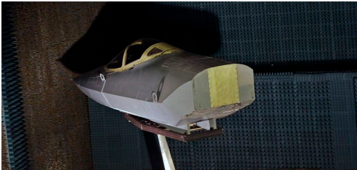
Рис. 2. Испытания фонаря кабины Су-57 на уровень ЭПР
