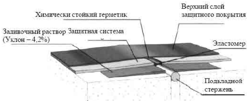
Рис. 3. Устройство деформационного шва
