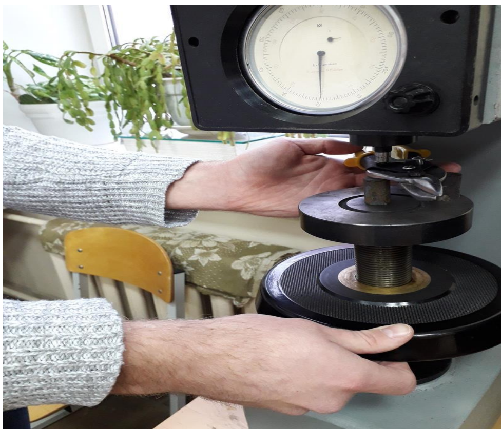
Рис. 4. Замер твердости на «ТР5006М»
