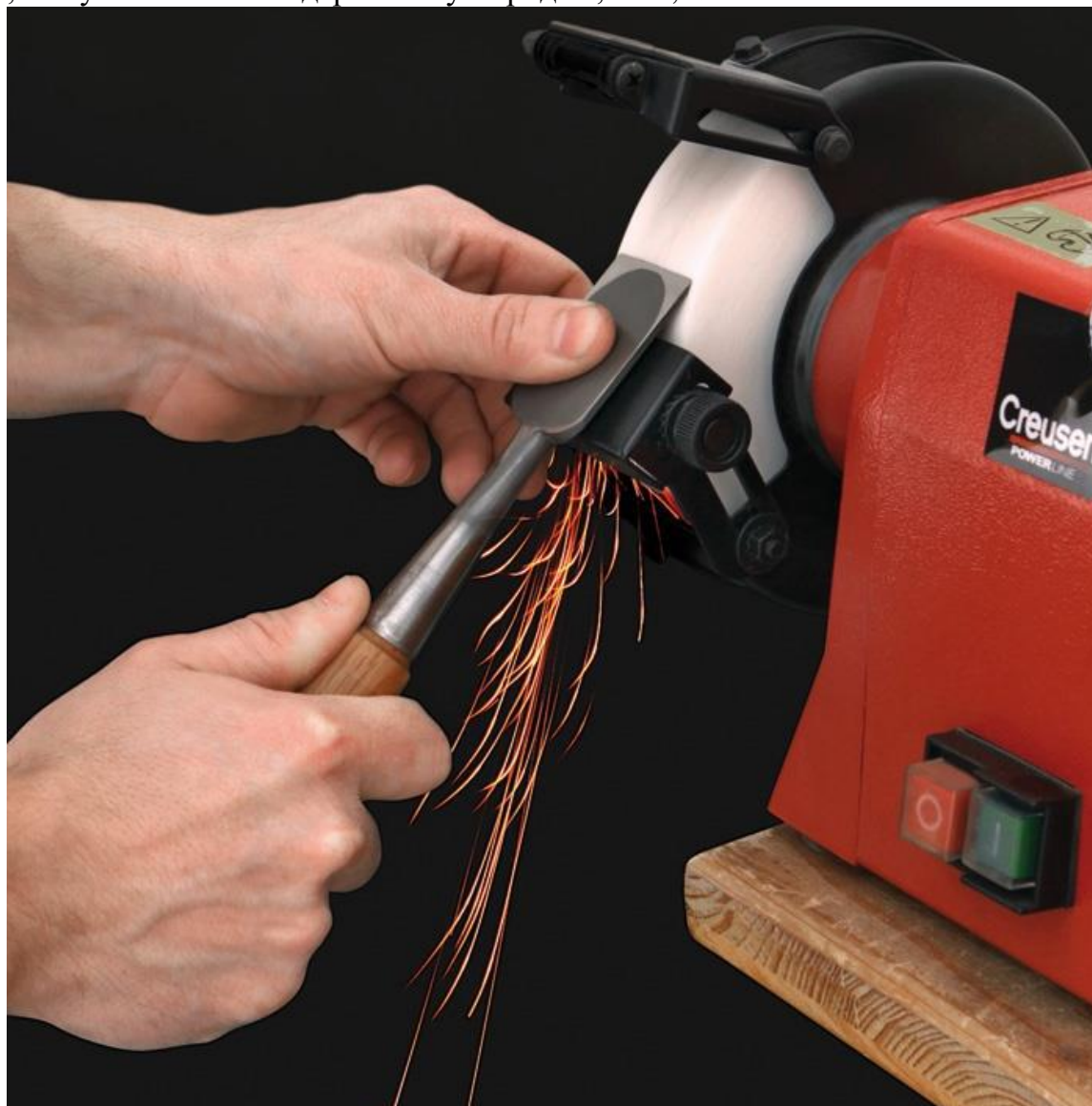
Рис. Извлечение искрового потока при экспресс-методе марочной оценки стали
