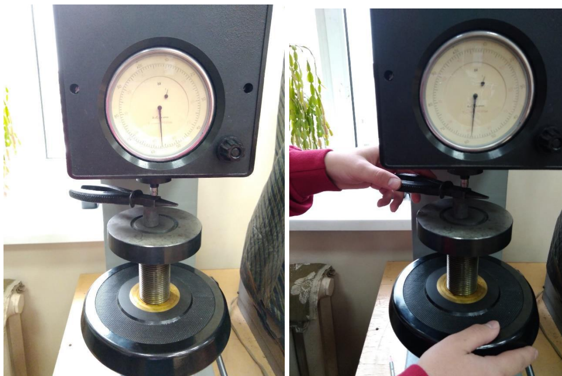
Рис. 4. Измерение твердости по методу Роквелла на плоскогубцах образца № 2
