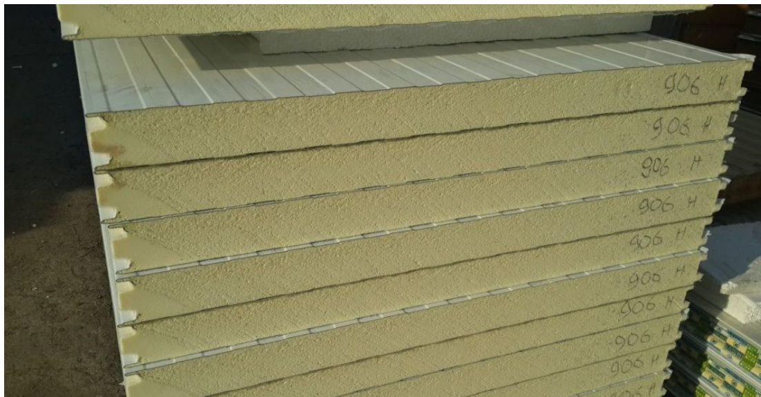
Рис. 2. Сэндвич-панель с утеплителем в виде пенополиуретана
