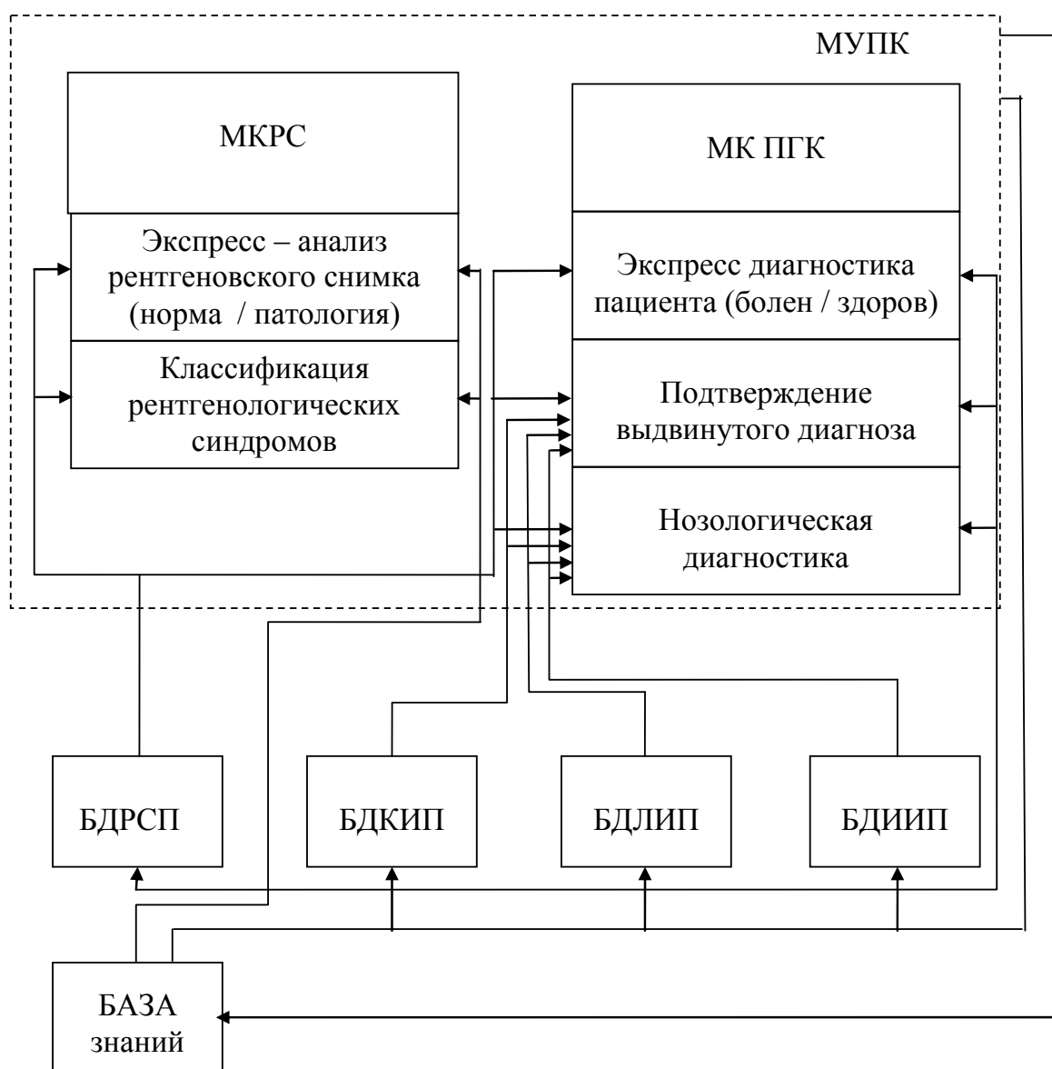
Рис. 1. Структура автоматизированной системы диагностики заболеваний легких
