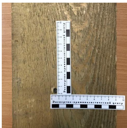
Рис. 9. Экспериментальная мишень. Повреждение, образованное при выстреле из карабина «Вепрь Хантер 308» с дистанции 10 м от дульного среза ствола карабина
