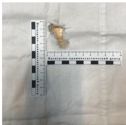
Рис. 14. Экспериментальная мишень. Повреждение, образованное при выстреле из ружья двуствольного «Винчестер Селект 12 калибра» с 5 м
