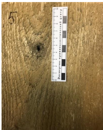
Рис. 8. Экспериментальная мишень. Повреждение, образованное при выстреле из карабина «Вепрь Хантер 308» с дистанции 15 см от дульного среза ствола карабина
