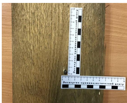
Рис. 10. Экспериментальная мишень. Повреждение, образованное при выстреле из карабина «Вепрь Хантер 308» с дистанции 10 м от дульного среза ствола карабина
