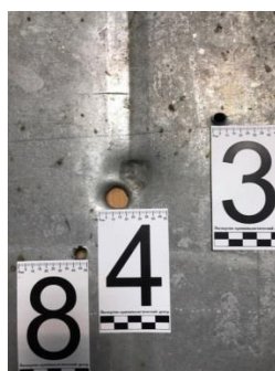
Рис. 17. Экспериментальные мишени. Повреждения, образованные при выстреле из карабина «Вепрь Хантер 308» и ружья двуствольного «Винчестер Селект 12 калибра» с 5 м
