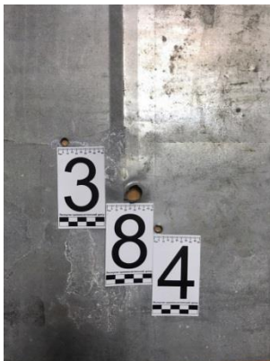
Рис. 16. Экспериментальные мишени. Повреждения, образованные при выстреле из карабина «Вепрь Хантер 308» и ружья двуствольного «Винчестер Селект 12 калибра» с 5 м
