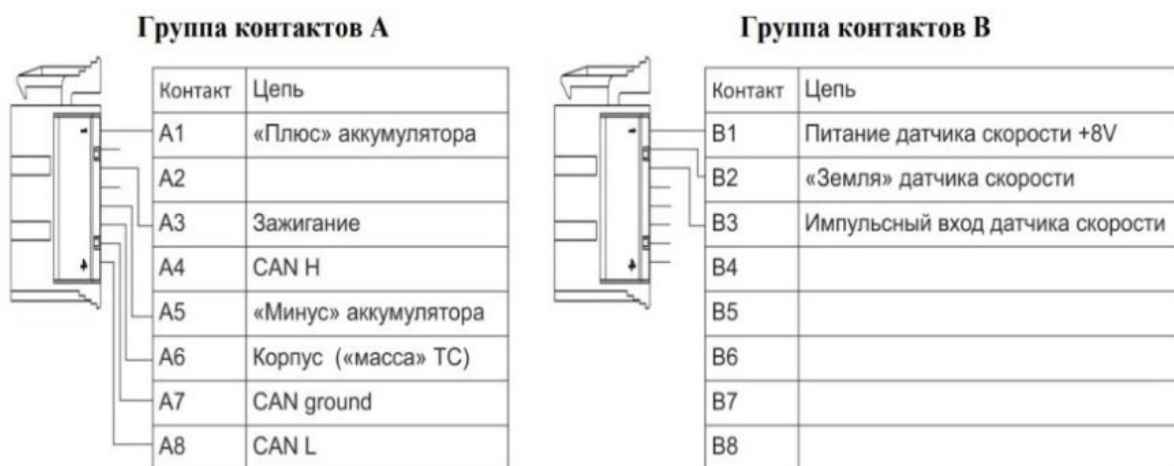
Рис. 3. Базовая схема включения+приборы с CAN [19]
