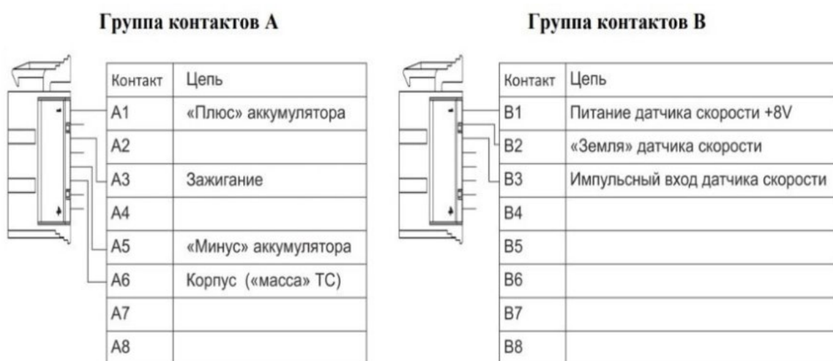
Рис. 4. Базовая схема включения+приборы без CAN [19]
