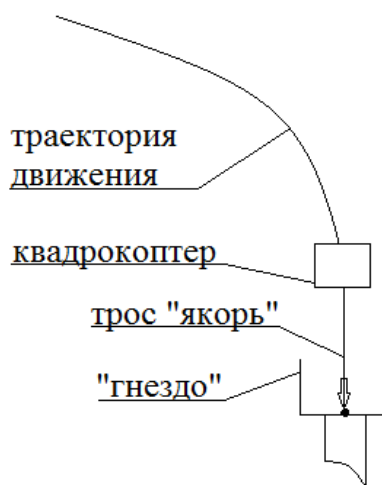
Рис. 4. Гарантированная посадка квадрокоптера в «гнездо»
