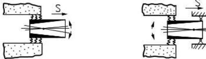
Рис. 3. Колебания детали на выходе ее из зоны резания
