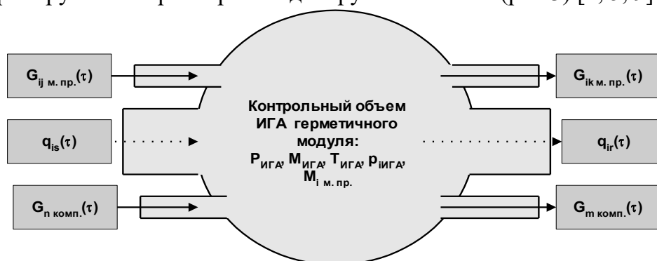
Рис. 3. Формирование потоков данных искусственной газовой атмосферы
