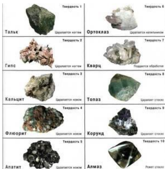
Рис. 1. Образцы материалов для измерения твёрдости
