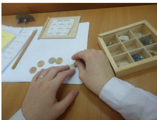
Рис. 2. Подбор образцов по Моосу, соответствующих твёрдости монет
