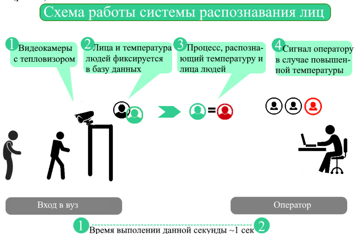
Рис. 2. Схема работы системы распознавания лиц
