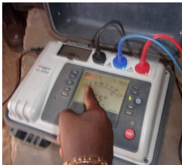
Рис. 13. Мегаомметр
