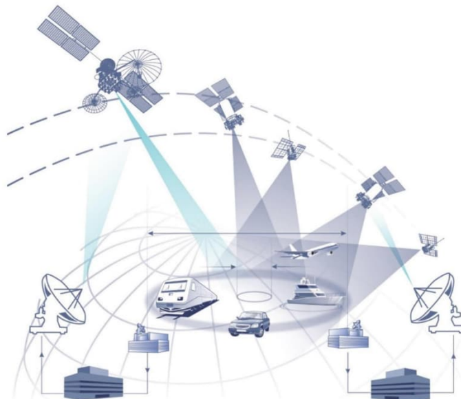
Рис. 1. Схема работы абонентов наземного сектора системы ESIM [16]
