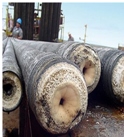
Рис. 2. Солеотложение в процессе добычи
