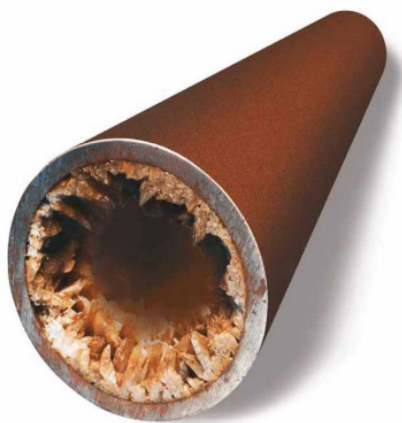
Рис. 1. Солеотложение процессе транспорта скважиной продукции
