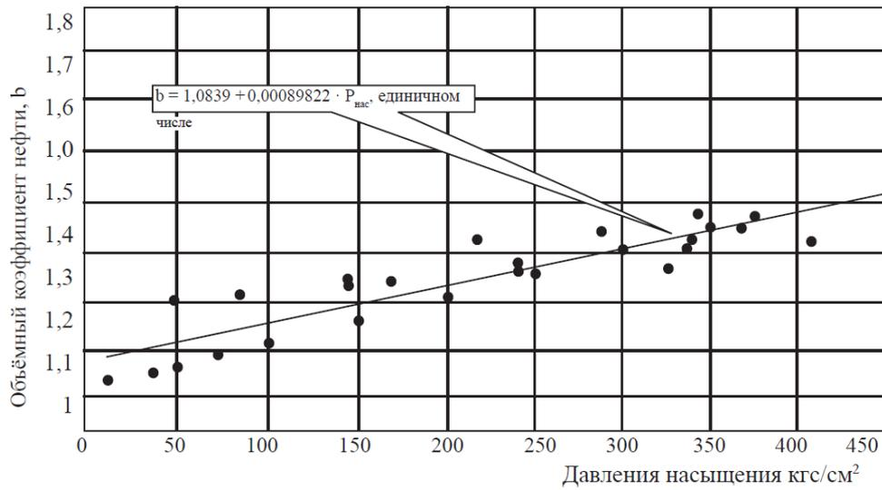
Рис. 5. Зависимость объёмного коэффициента нефти на давления насыщения
