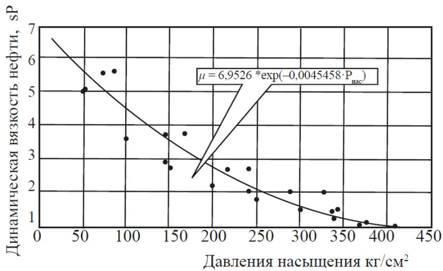
Рис. 6. Зависимость динамической вязкости нефти на пластовое давление
