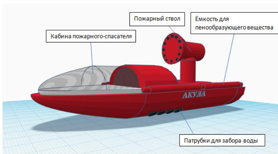
Рис. 1. Общий вид пожарного катера «Акула»
