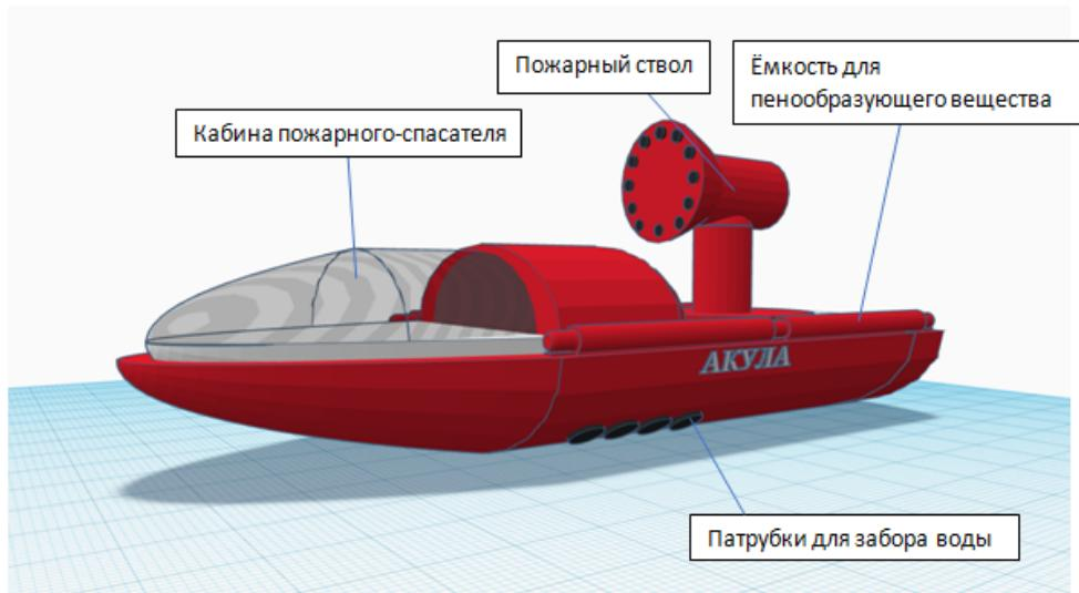
Рис. 1. Общий вид пожарного катера «Акула»
