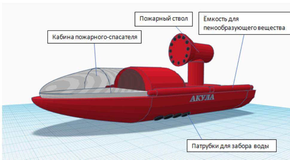
Рис. 1. Общий вид пожарного катера «Акула»
