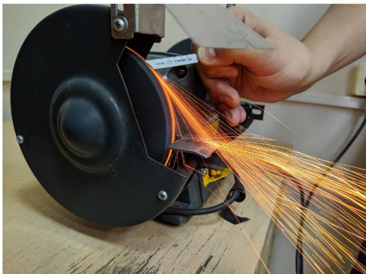
Рис. 5. Проба на искру образца №2
