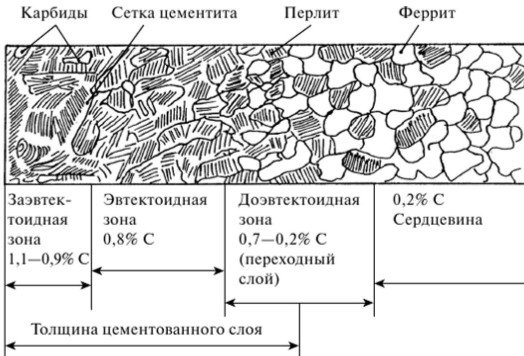
Рис. 1. Структура цементированной стали
