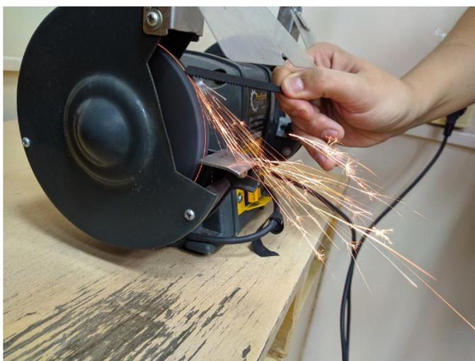
Рис. 4. Проба на искру образца №1
