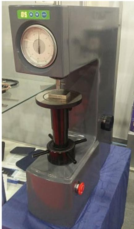
Рис. 2. Стационарный твердомер «TP5006M»
