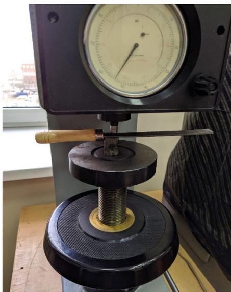
Рис. 2. Измерение твёрдости образцов по Роквеллу
