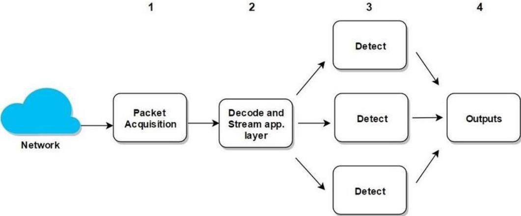
Рис. 3. Многопоточная операционная архитектура Suricata
