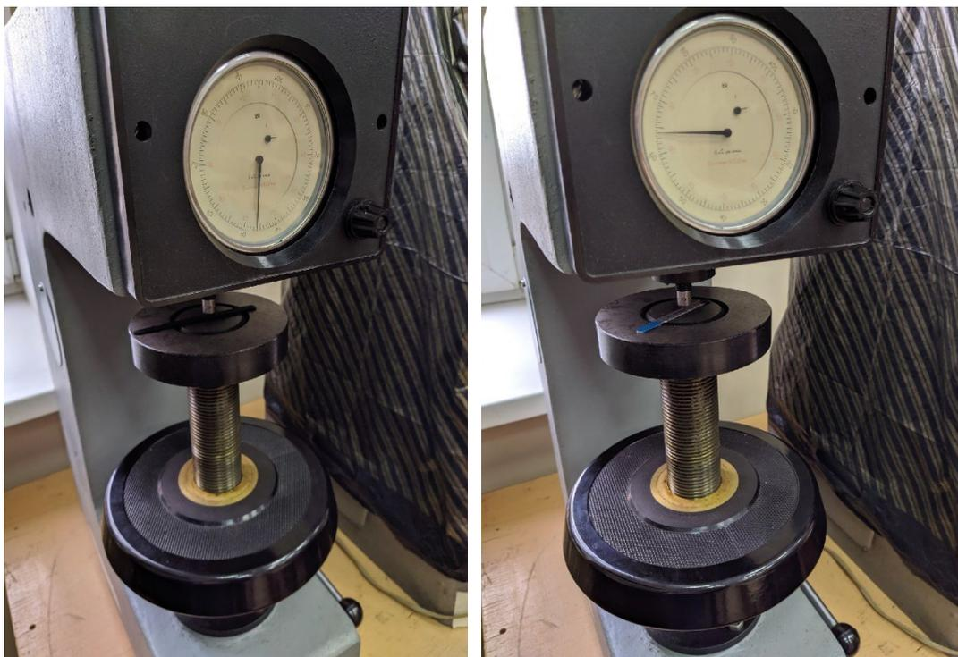
Рис. 3. Измерение твёрдости по методу Роквелла
