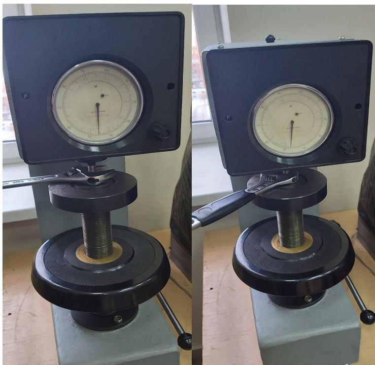
Рис. 2. Измерение твёрдости по методу Роквелла
