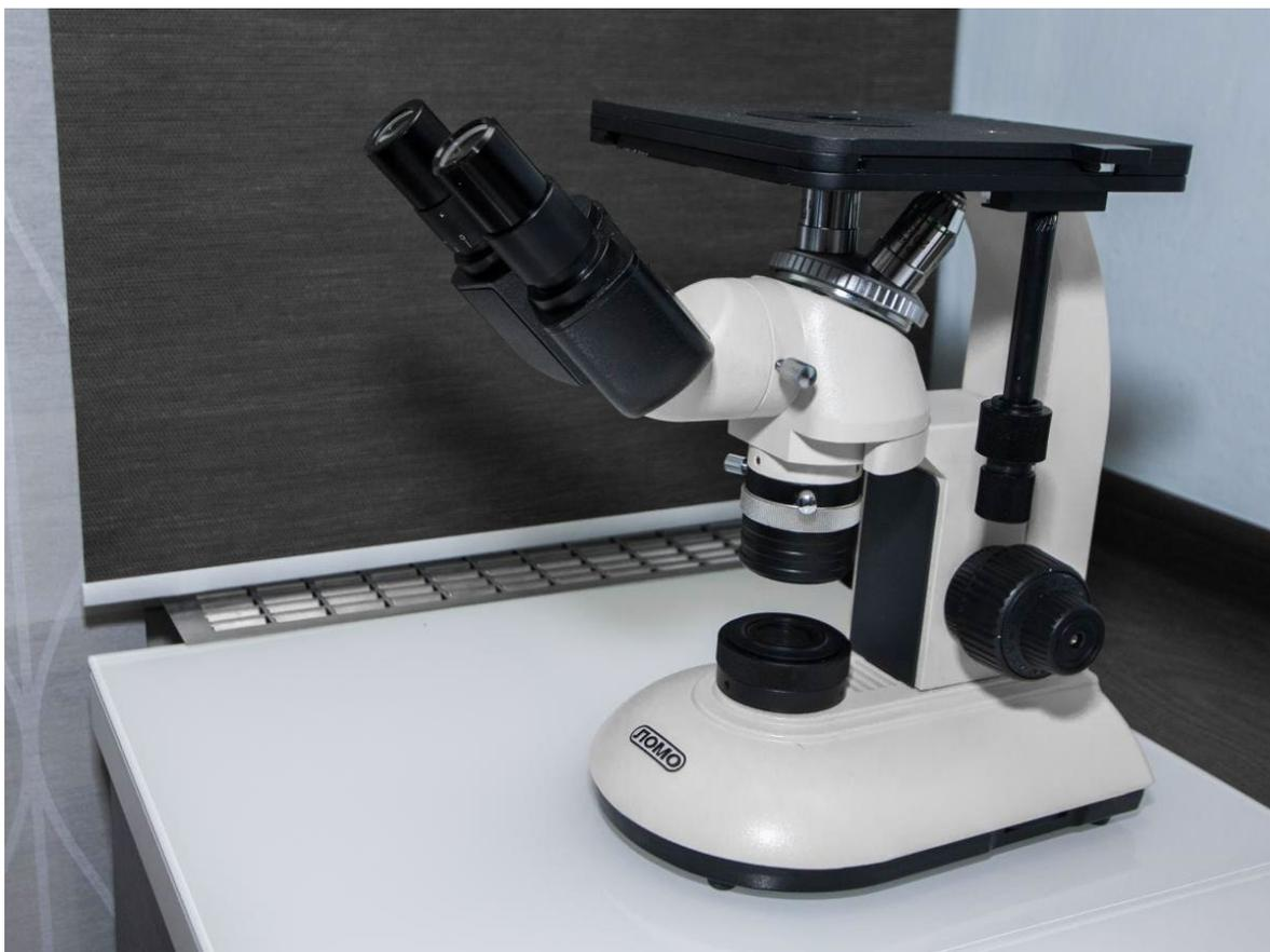
Рис. 3. Оптический металлографический микроскоп “МЕТАМ РВ-34”
