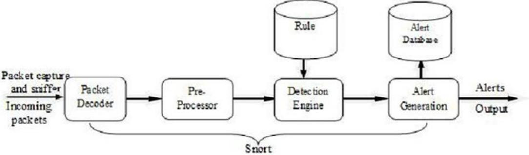
Рис. 1. Архитектура системы Snort IDS
