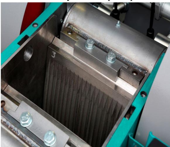
Рис. 6. Щеки дробилки
