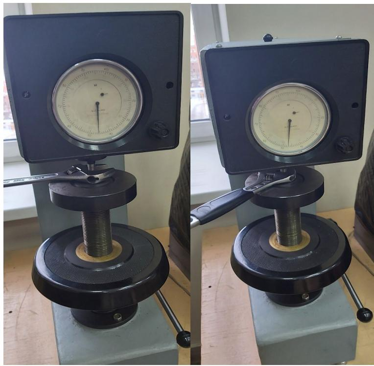
Рис. 2. Измерение твёрдости по методу Роквелла
