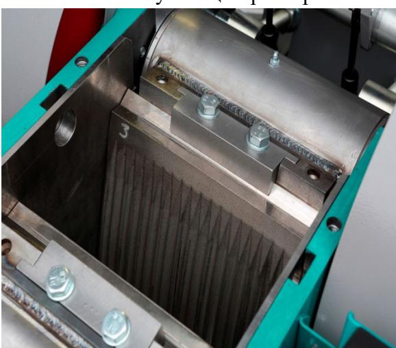
Рис. 6. Щеки дробилки
