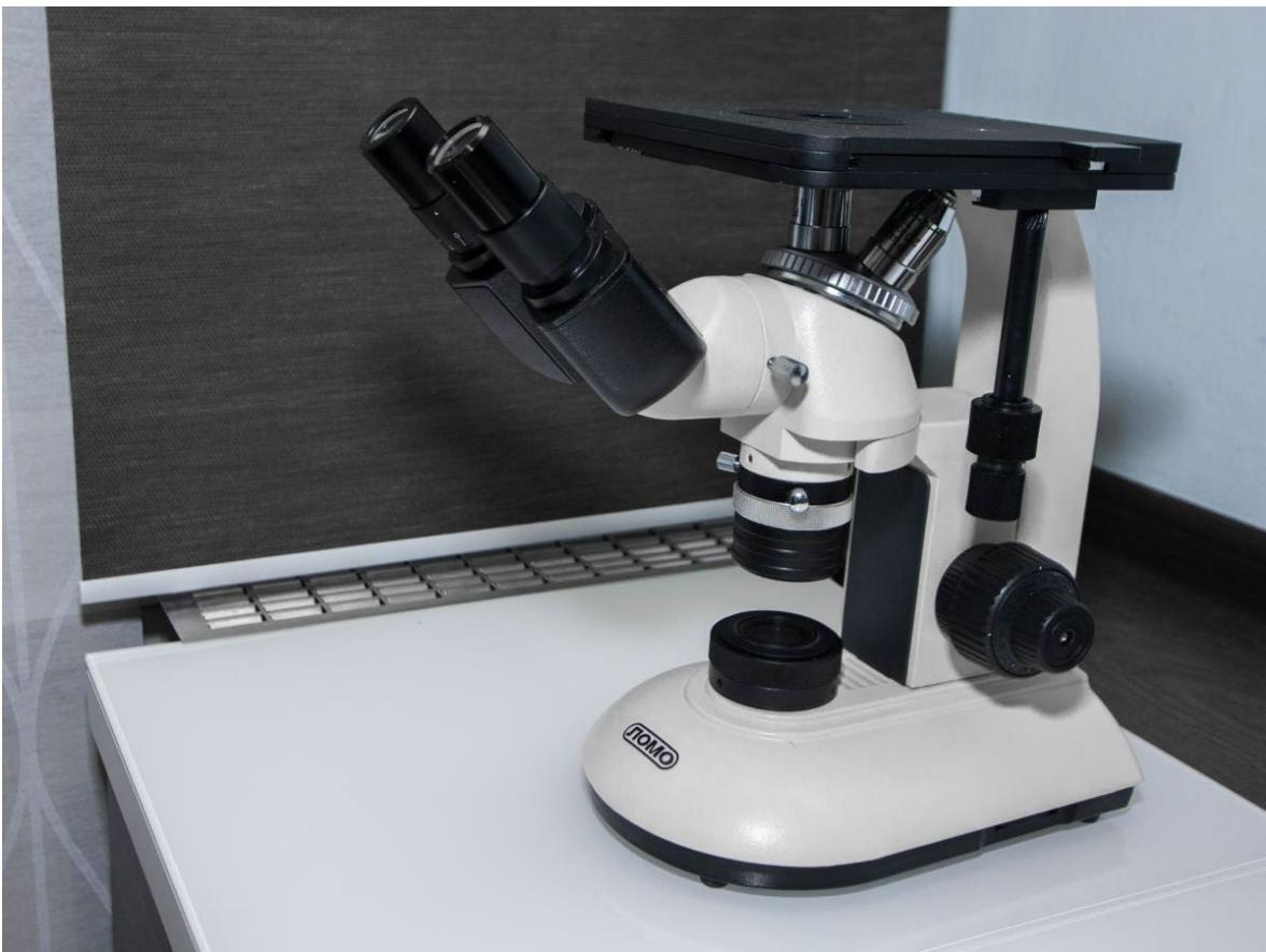
Рис. 3. Оптический металлографический микроскоп “МЕТАМ РВ-34”
