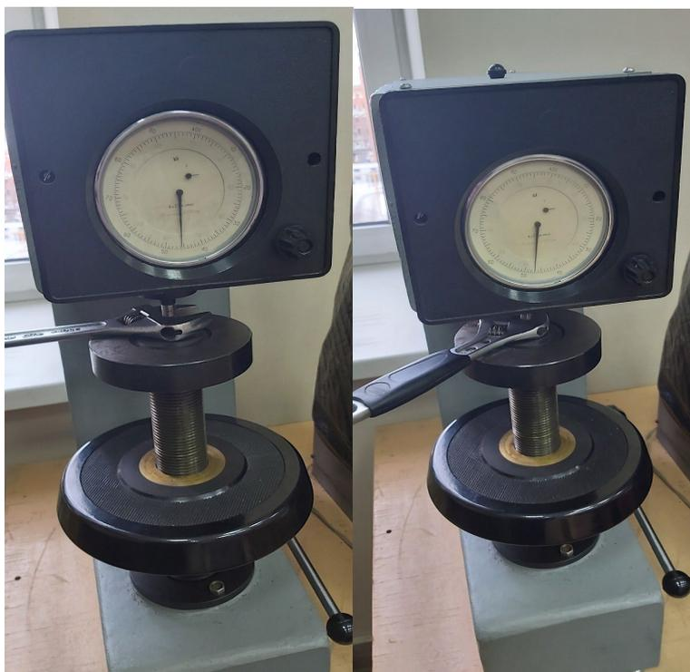
Рис. 2. Измерение твёрдости по методу Роквелла
