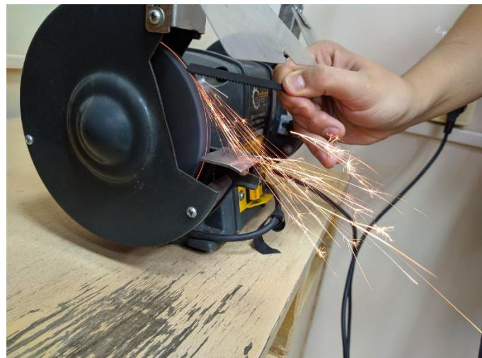
Рис. 4. Проба на искру образца №1
