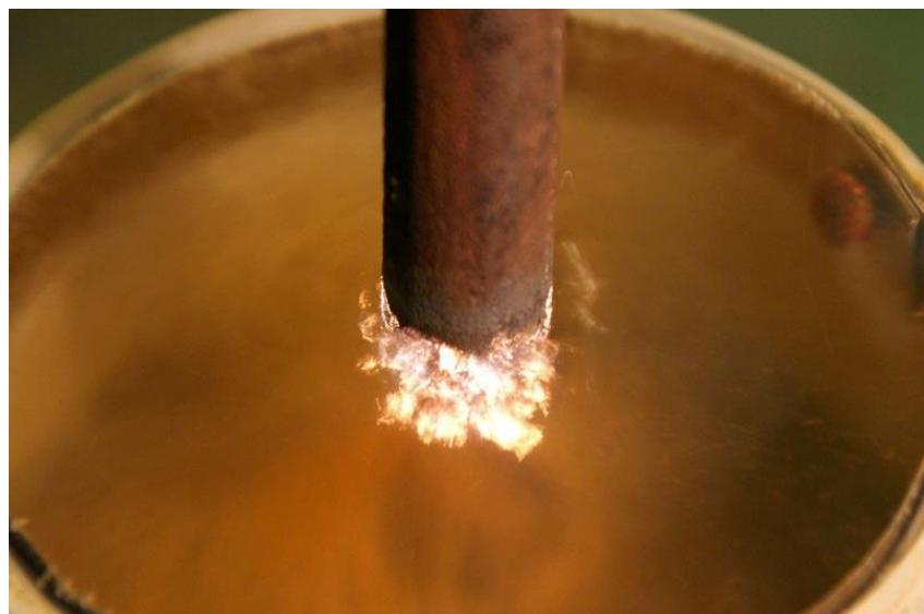
Рис. 3. Цементация металла в жидкой среде
