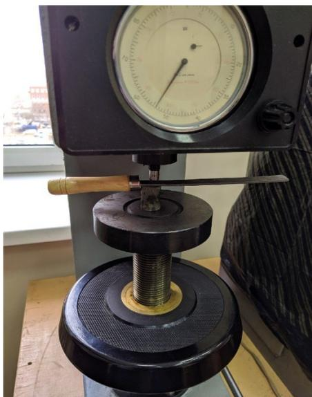
Рис. 2. Измерение твёрдости образцов по Роквеллу
