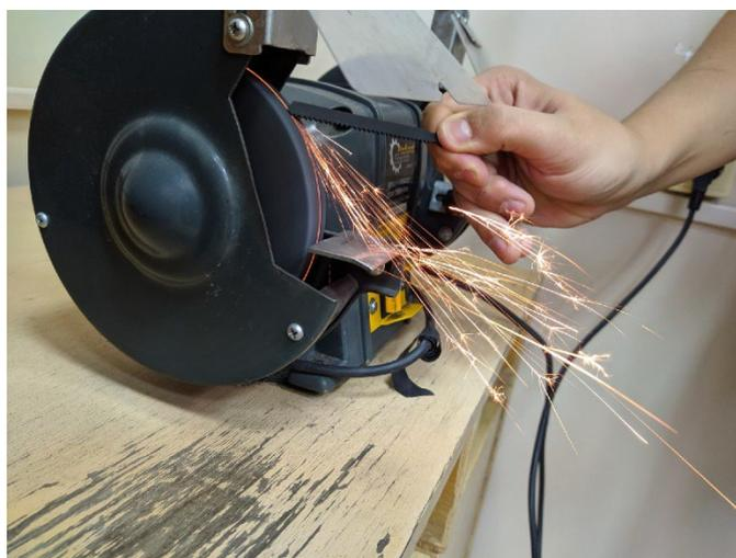
Рис. 4. Проба на искру образца №1
