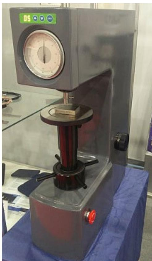
Рис. 2. Стационарный твердомер «TR5006M»
