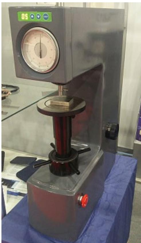
Рис. 2. Стационарный твердомер «TP5006М»
