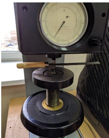
Рис. 2. Измерение твёрдости образцов по Роквеллу
