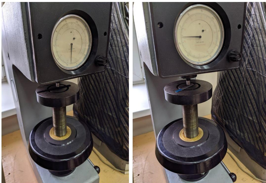
Рис. 3. Измерение твёрдости по методу Роквелла
