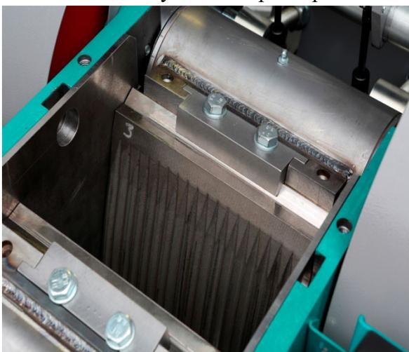
Рис. 6. Щеки дробилки
