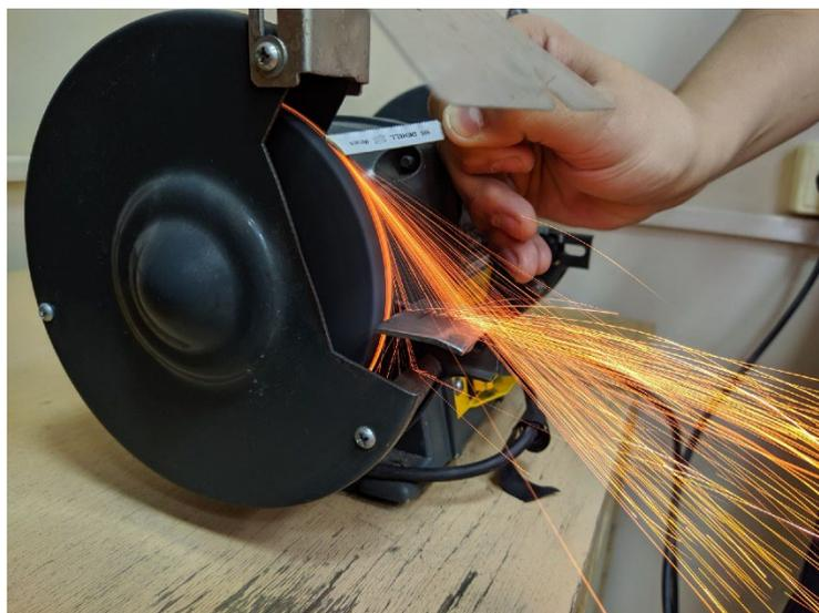
Рис. 5. Проба на искру образца №2
