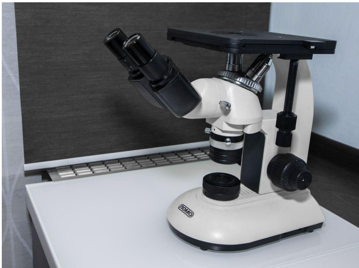
Рис. 3. Оптический металлографический микроскоп “МЕТАМ РВ-34”
