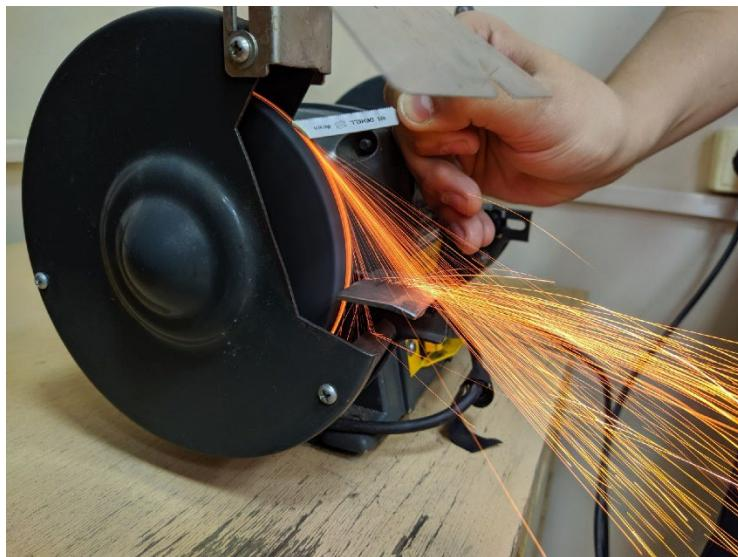
Рис. 5. Проба на искру образца №2
