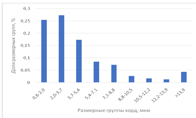
Рис. 2. Гистограмма распределения хорд случайных секущих на сечениях зерен по размерным группа сплава Sn–14 ат. % In–6,5 ат. % Zn
