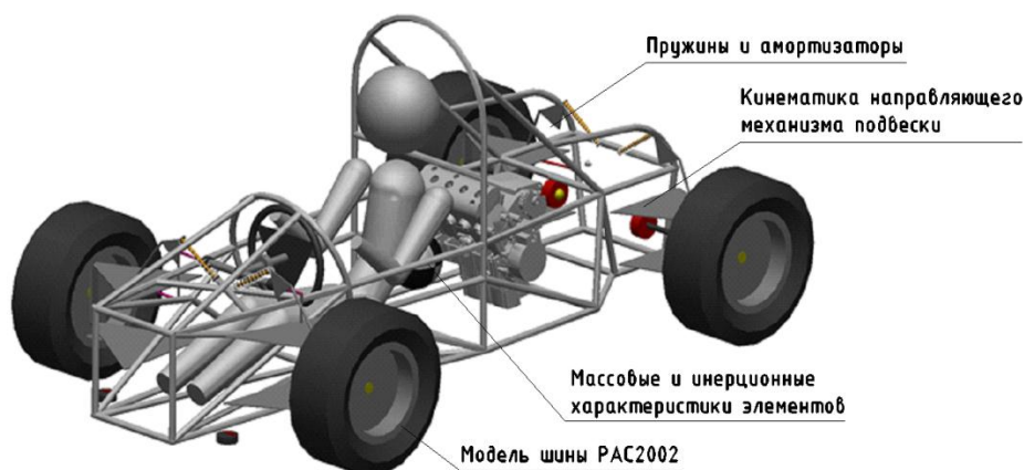
Рис. 3. Схема модели спортивного автомобиля класса “Formula SAE”
