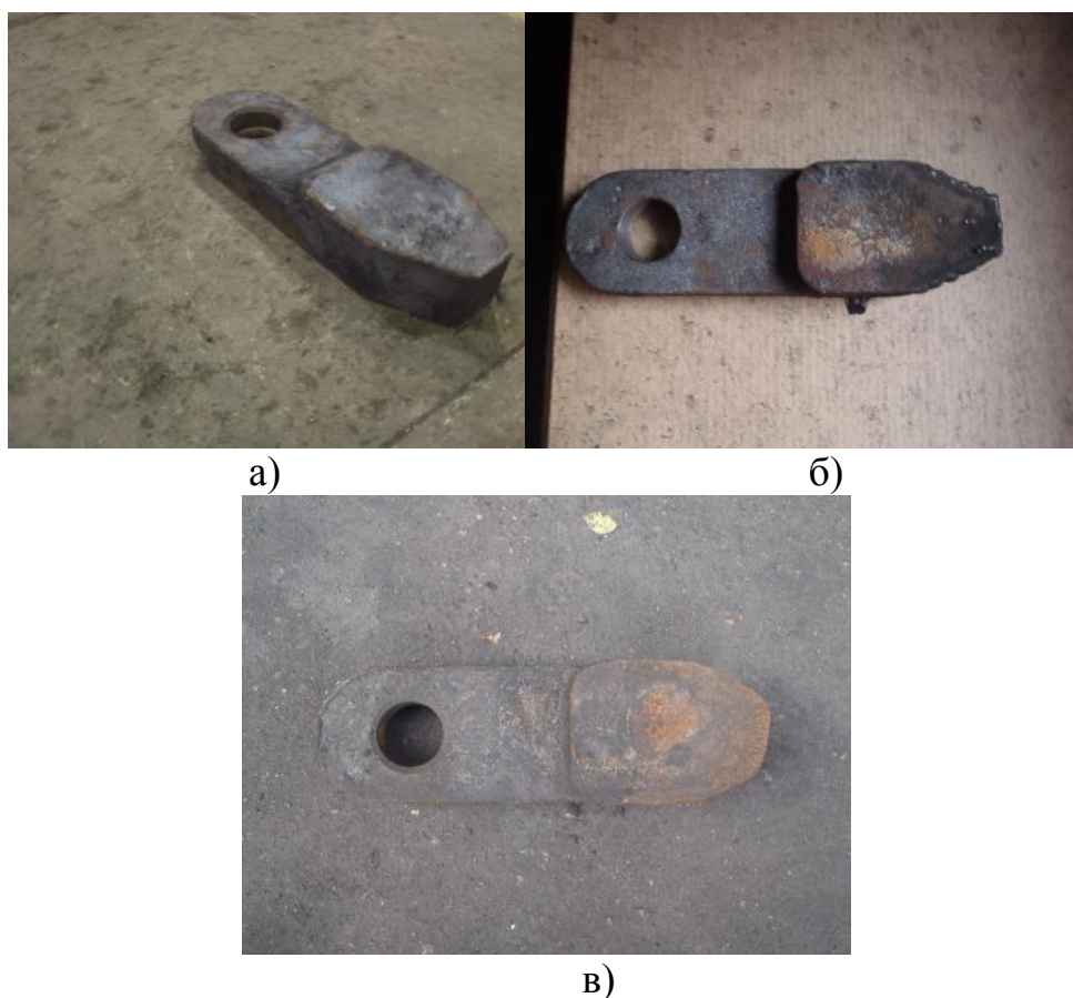
Рис. 6. Общий вид заготовки под наплавку (а), наплавленный молоток (б) и изношенный молоток (в)
