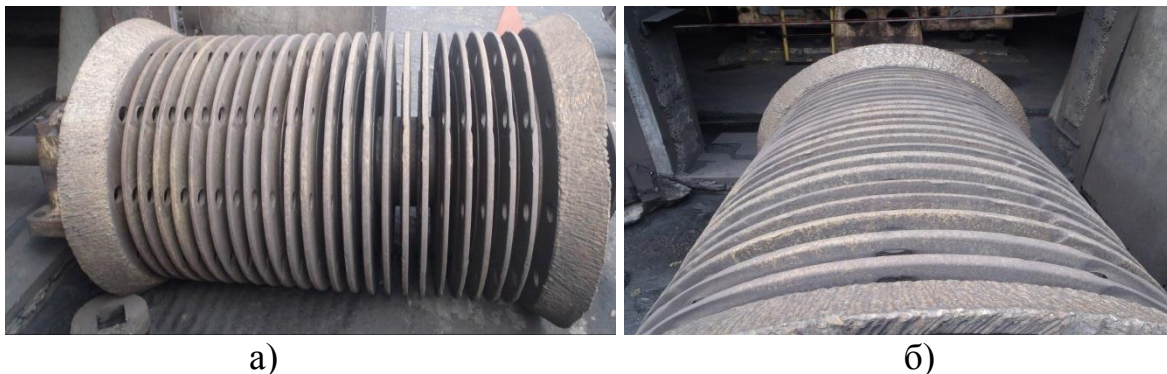
Рис. 5. Общий вид ротора с наплавленными крайними дисками: а – вид спереди; б – вид сбоку
