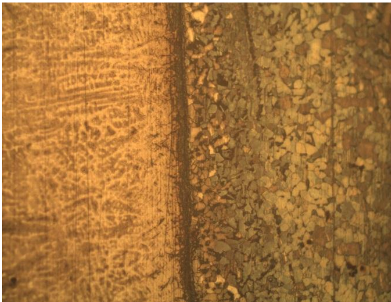
Рис. 5. Структура наплавленного металла в зоне сплавления основного металла с наплавленным металлом типа стали P18ЮН, \times 1000
