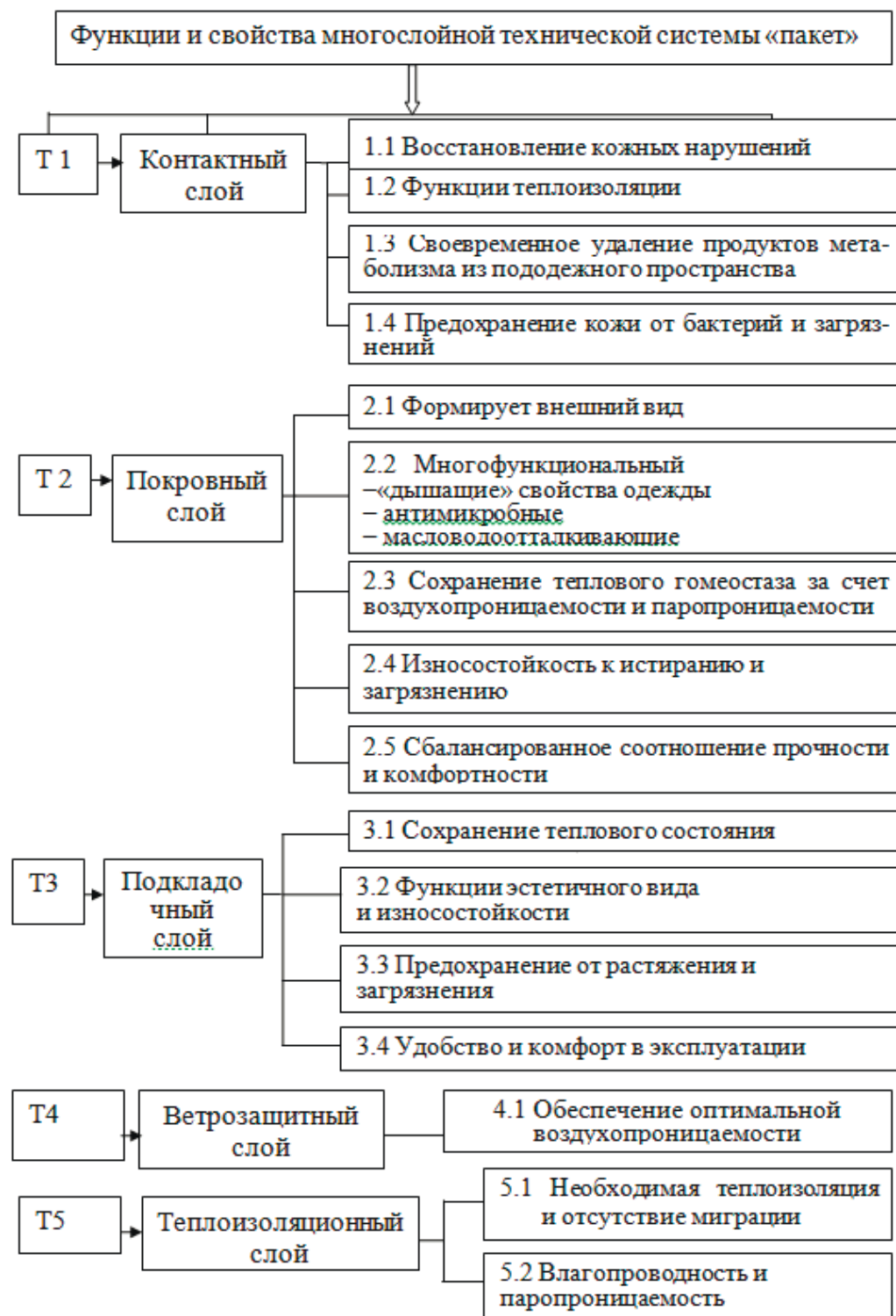
Рис. Функционально-морфологическая модель многослойной технической системы «пакет» материалов
