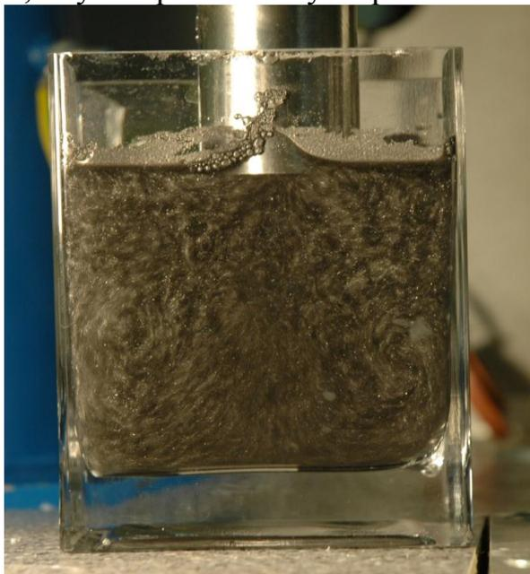
Рис. 1. Введение излучателя ультразвуковой колебательной системы в среду СОЖ
