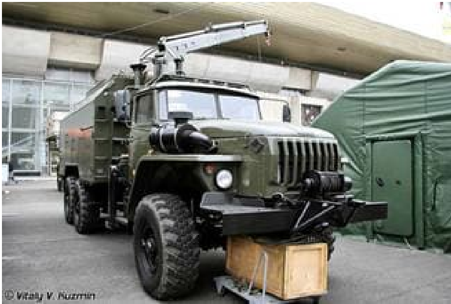
Рис. 2. Мастерская технического обслуживания и ремонта МТО-АМ2.1
