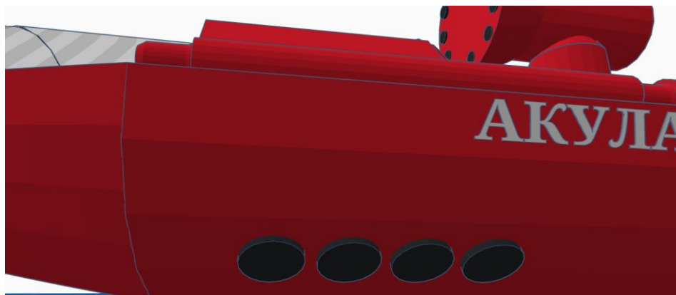
Рис. 3. Патрубки для забора воды
