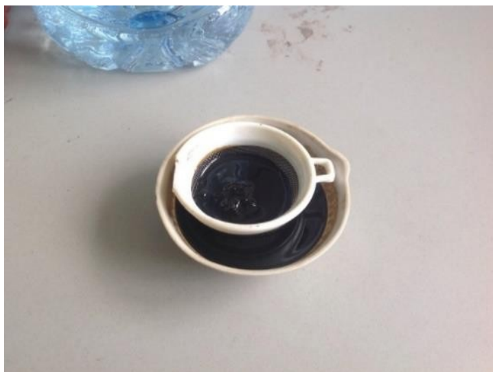
Рис. 8. Проверка нефтеёмкости образца
