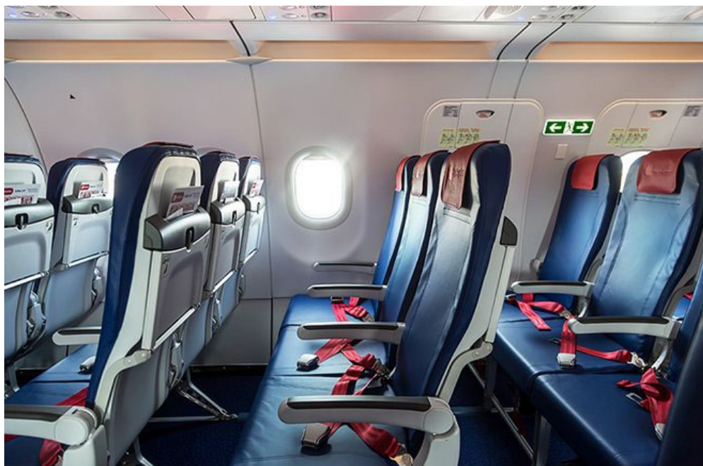
Рис. 1. Спинки и подлокотники пассажирских кресел, изготовленные из сплава МА20СП
