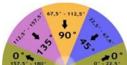
Рис. 4. Принцип деления направлений \theta на категории
