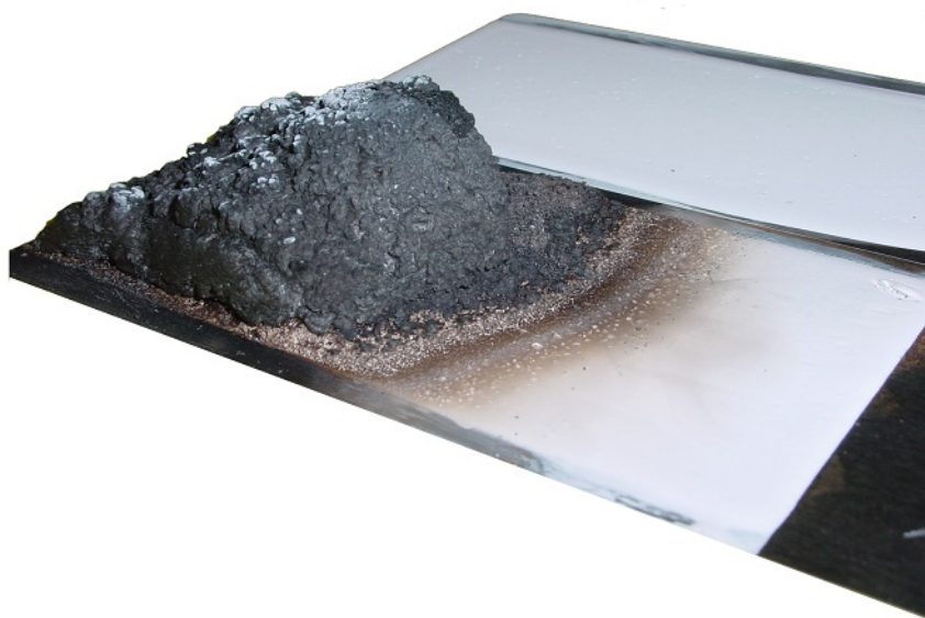
Рис. 2. Терморасширяющийся состав после огневого воздействия
