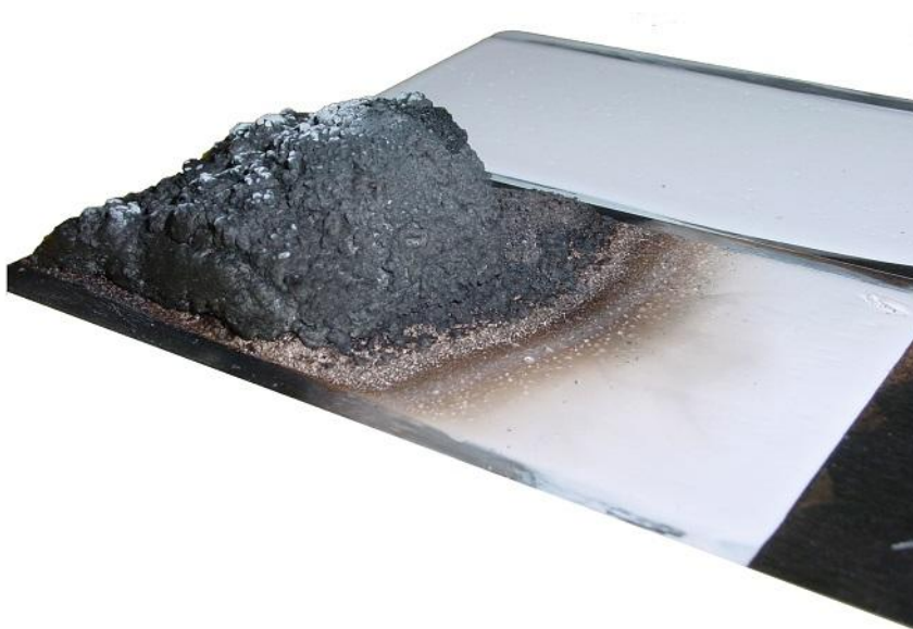
Рис. 2. Терморасширяющийся состав после огневого воздействия
