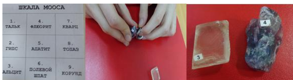
Рис. 4. Определение твердости ювелирных изделий по шкале Мооса
