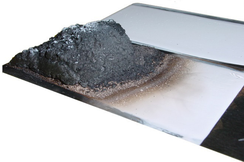
Рис. 2. Терморасширяющийся состав после огневого воздействия
