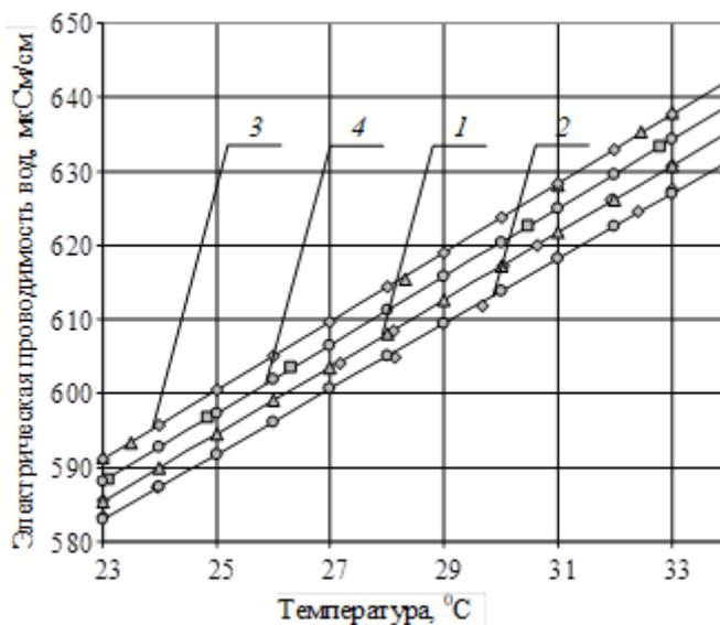
Рис. 8. Электрическая проводимость артезианской воды, пропущенной через УСВР при введении наноструктурированных металлов при различной температуре:
