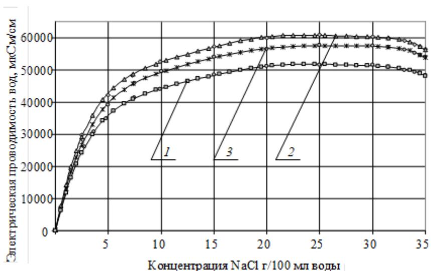
Рис. 1. Электрическая проводимость вод различной кластерной структуры в зависимости от количества соли (NaCl), вводимой в растворитель:
