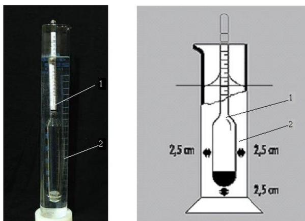
Рис. 1. Установка для определения плотности растворителя (слева - фотография, справа - схематический чертеж):
