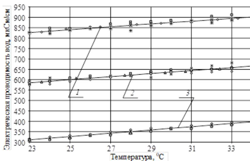
Рис. 3. Электрическая проводимость вод различной кластерной структуры при различных температурах при ведении нанометала Fe:
