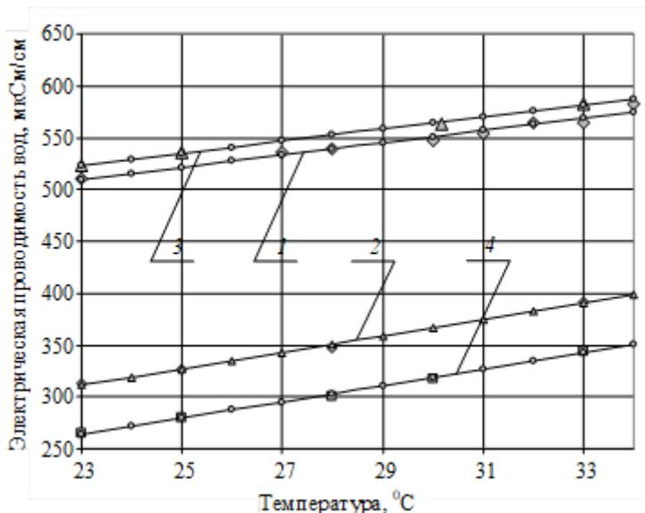
Рис. 7. Электрическая проводимость талой артезианской воды при введении наноструктурированных металлов при различной температуре:
