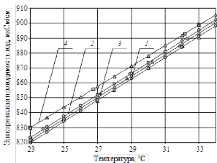
Рис. 6. Электрическая проводимость артезианской воды при введении наноструктурированных металлов при различных температурах:
