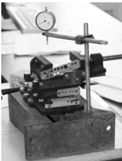
Рис. 8. Установка для измерения поверхности образца
