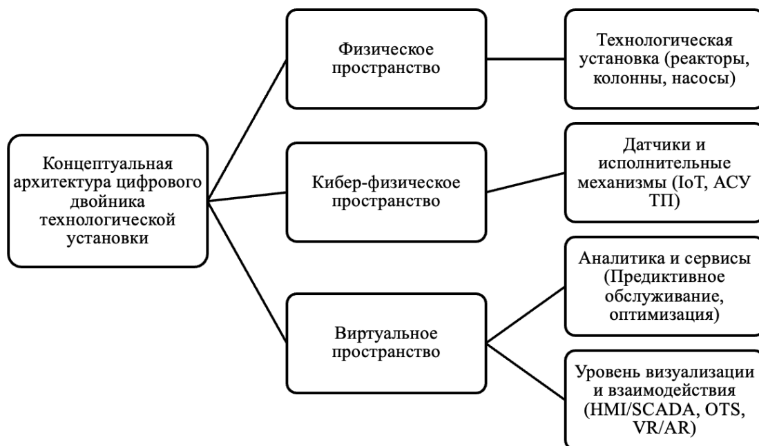
Рис. 1. Концептуальная архитектура цифрового двойника технологической установки (составлено автором на основе [2, с. 123-132; 4, с. 115-121; 9, с. 133-180])
