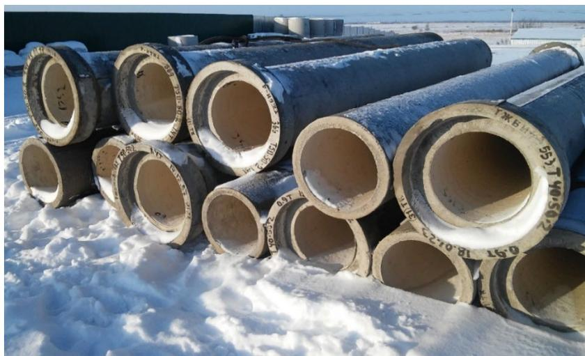
Рис. 2. Железобетонные трубы
