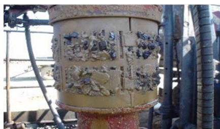
Рис. 2. Места солеотложений на насосном оборудовании
