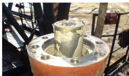
Рис. 2. Места солеотложений на насосном оборудовании
