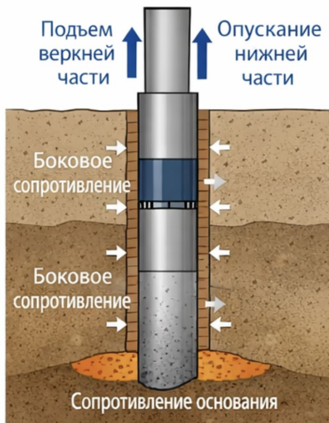
Рис. 1. Схема двунаправленного нагружения сваи
