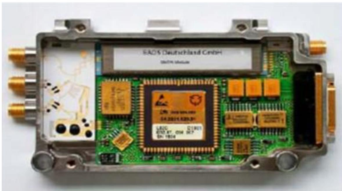
Рис. 20. Модуль СВЧ АФАР X-диапазона
