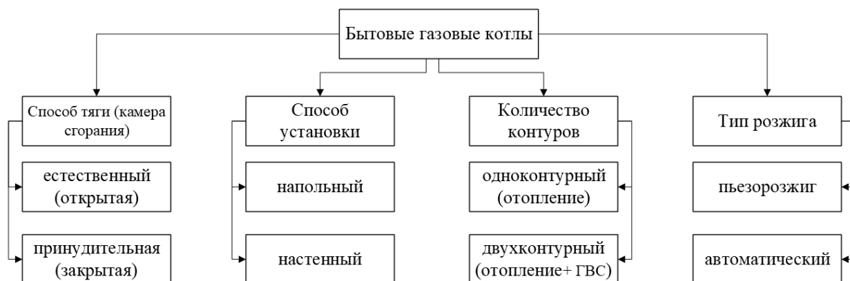
Рис. 2. Схема классификации бытовых газовых котлов
