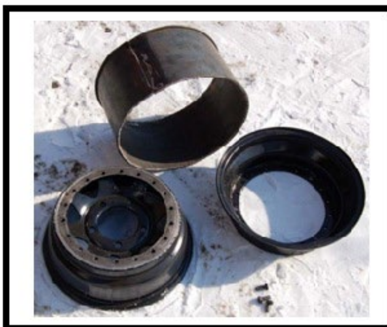
Рис. 3. Разборное колесо с распорным кольцом
