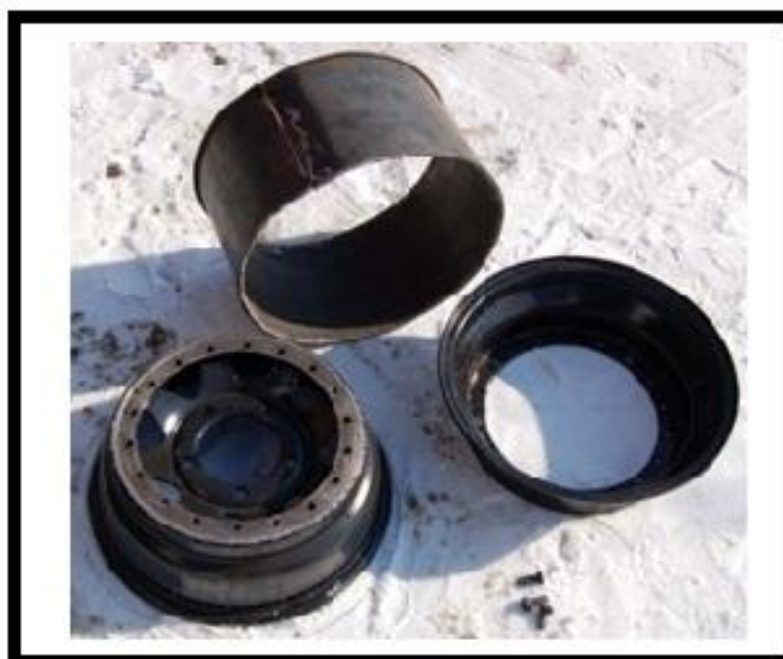
Рис. 3. Разборное колесо с распорным кольцом
