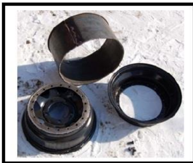
Рис. 3. Разборное колесо с распорным кольцом
