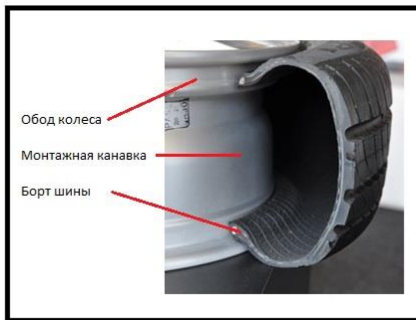
Рис. 1. Шина обычной конструкции
