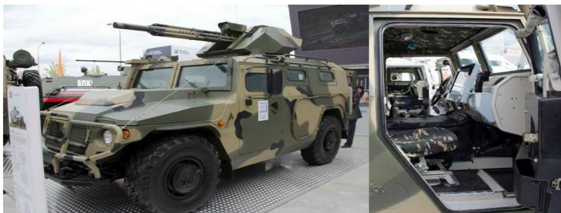
Рис. 2. ДУМВ с пушкой 2А72 калибра 30 мм на бронев автомобиле «Тигр»
