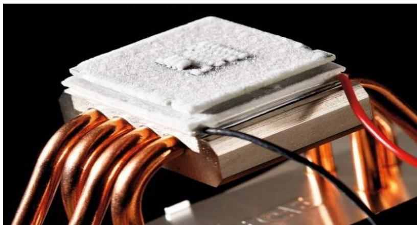
Рис. 9. Система охлаждения на элементах Пельтье
