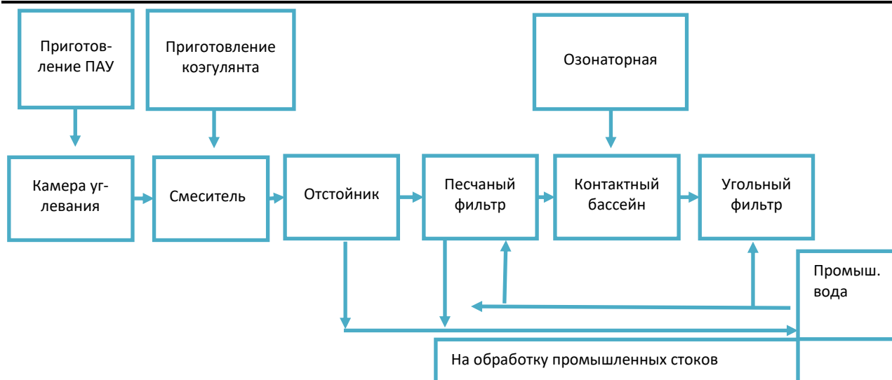
Рис. 1. Технологическая схема очистного сооружения
