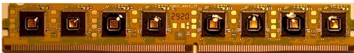
Рис. 2. Модуль нейроморфного ускорителя с 8 прототипами НП «Алтай»
