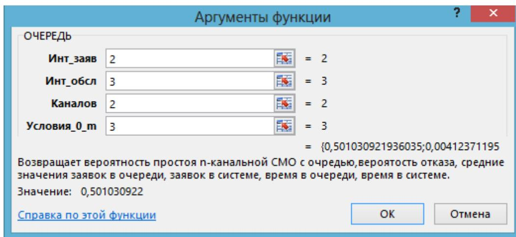
Рис. 3.3. Применение функции ОЧЕРЕДЬ в примере 3.2
