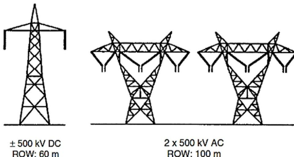
Рис. Приблизительная ширина земельных участков, предоставляемых под опоры воздушных линий электропередачи в постоянное (бессрочное) пользование
