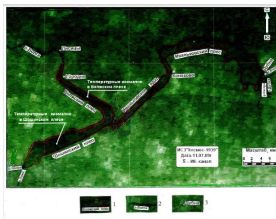
Рис. 25. Космический тепловой снимок района Ивановского водохранилища в тепловом диапазоне. ИСЗ «Космос-1939». 5 канал,  $\lambda \lambda - 10,3-11,8$  мкм. Дата съемки – 11 июля 1989года. Данные ГЦ ПОД Росгидромета. Московская область, г.Долгопрудный. 1990 год. 1 – темные фототона, соответствуют участкам земной поверхности и поверхностных вод с низкими температурами; 2 – реки, 3 – населенные пункты
