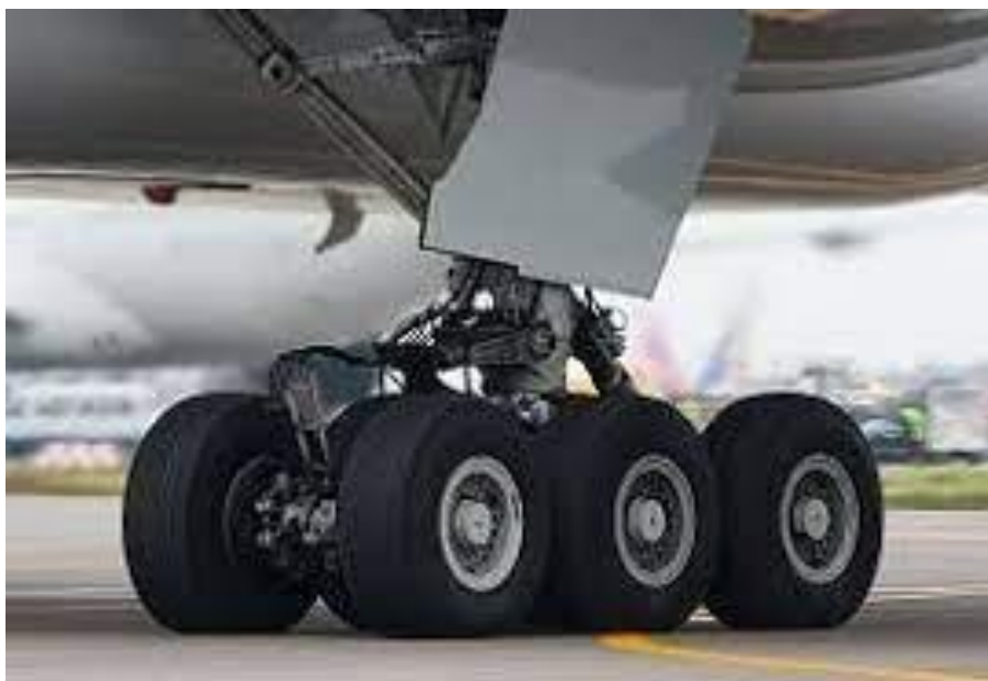
Рис. 2 Авиационные колеса из магниевого сплава
