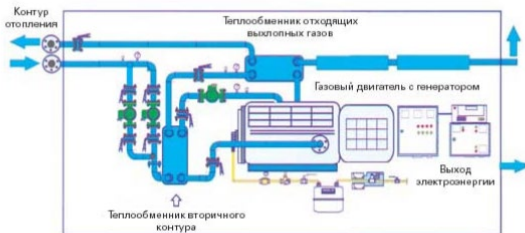
Рис. 2. Схема газопоршневой установки
