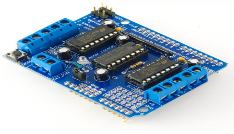
Рис. 1. Плата расширения L293D Motor Driver Shield
