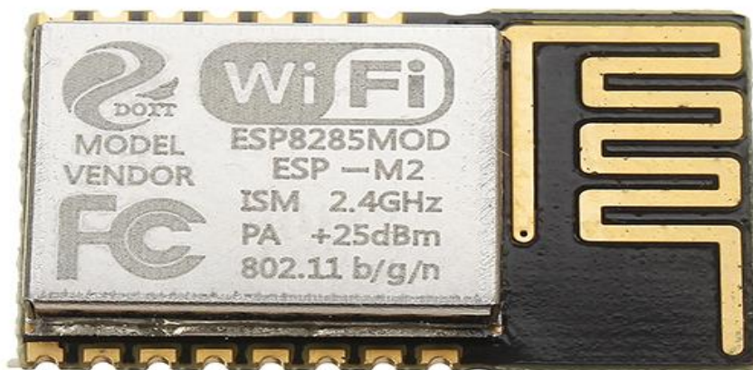
Рис. 2. Wi-Fi модуль ESP-2M
